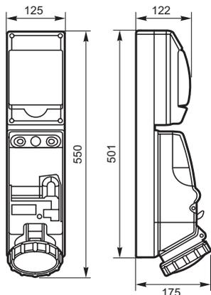
Coffret monoprise 63A avec interrupteur version encastrée
