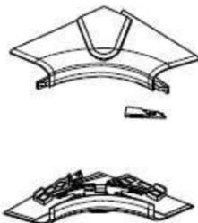
Les angles intérieurs comprennent 3 éléments (ex : pour goulotte 2 compartiments avec jonction de cloison)
