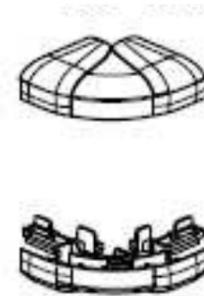
Les angles extérieurs comprennent 3 éléments (ex : pour goulotte 2 compartiments avec jonction de cloison)
