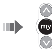
Le moteur monte, il faut changer le sens de rotation
