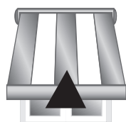
Le moteur monte, il faut changer le sens de rotation
