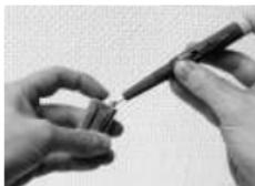
Lors du contrôle, le doigt d'une des mains doit toucher la vis de l'appareil. Toucher simultanément l'un des pôles de la pile avec la pointe de contrôle et l'autre pôle de la pile avec la main libre.
