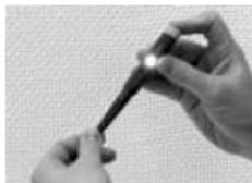
Un autotest doit être effectué avant chaque utilisation de l'appareil pour s'assurer le fonctionnement correct. Pour cela, touchez la pointe de contrôle d'une main et la vis de l'appareil de l'autre main. Le cligno-
