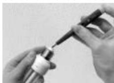
Lors du contrôle, le doigt d'une des mains doit toucher la vis de l'appareil. Toucher simultanément le point de contrôle de l'objet avec la pointe du testeur et le côté opposé du point de contrôle avec la main
