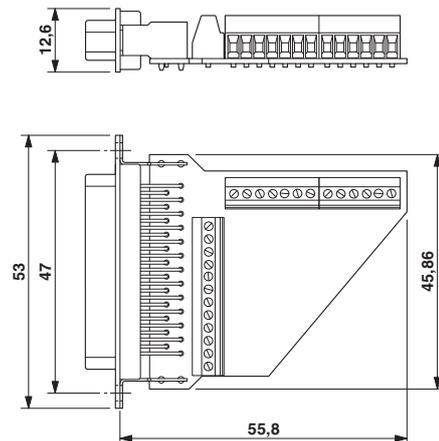
Élément pour contacts SUB-D, raccordement vissé
