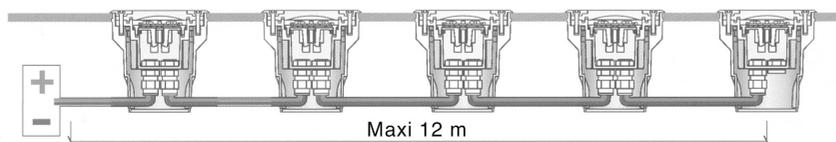
Utiliser du câble H05RN-F 2x 0,75 mm<sup>2</sup> Ø7 mm maxi. pour installation dans le sol.
