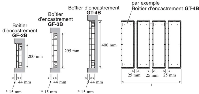
\* Ne pas encastrer le boîtier de plus de 15 mm par rapport à la surface extérieure du mur.
