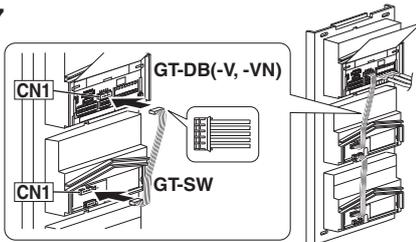
**7** Du module audio au module suivant, insérer le connecteur fourni dans le support.
