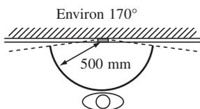
Une zone de couverture d'environ 170° dans un rayon de 500 mm à partir de la caméra. (Le rayon d'affichage est une estimation brute et peut varier en fonction à l'environnement d'installation).
