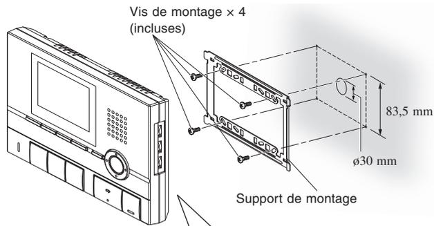
\* Lors de l'utilisation d'un boîtier de raccordement électrique, un boîtier de raccordement électrique triple est recommandé.
