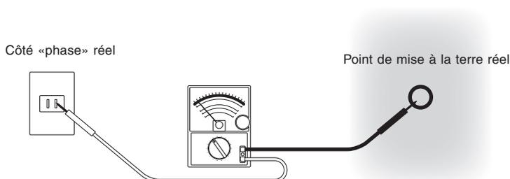
**4** Connecter la borne de mise à la terre de l'alimentation [⏏] à l'aide du point de mise à la terre trouvé dans l'étape 3.
