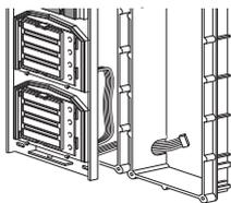
**9** Faire passer les câbles de connexion dans le tube de raccord et connecter CN1 du GT-SW à la rangée suivante.
