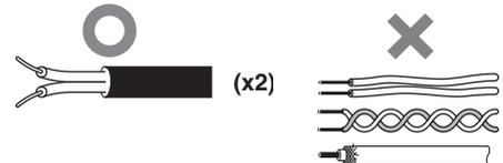
**Pour connecter des fils basse tension, soit les sertir avec un manchon de sertissage, soit les souder, puis isoler en couvrant avec du ruban isolant.**
