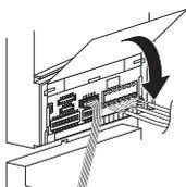
**11** Fermer le cache-bornier. Monter l'encadrement et procéder au serrage à l'aide du tournevis spécial (compris avec le GT-BC).
