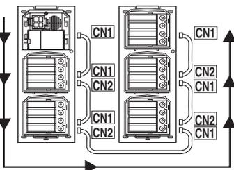
**8** Fixer les câbles de connexion entre les modules. Monter les modules sur les boîtiers d'encastrement.
