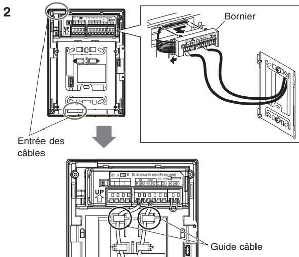
**2** Raccorder les câbles au bornier.
