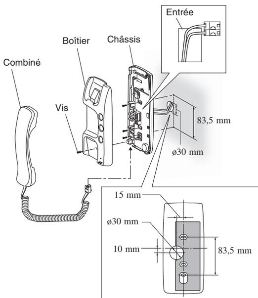
**1** Retirer la vis, puis retirer l'encadrement depuis le châssis.
