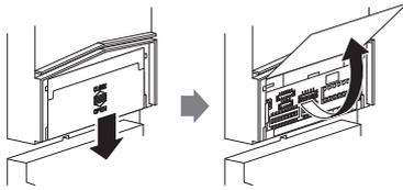
**6** Faire glisser le cache-bornier vers le bas pour l'ouvrir et brancher les câbles au bornier. Insérer le câble directement dans la borne. Appuyer sur l'onglet pour facilement insérer le câble dans la borne, puis relâcher.
