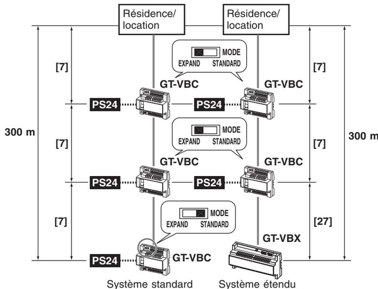
Le GT-VBC peut également être utilisé en tant qu'adaptateur d'extension (2 centrales par ligne de jonction secondaire).
