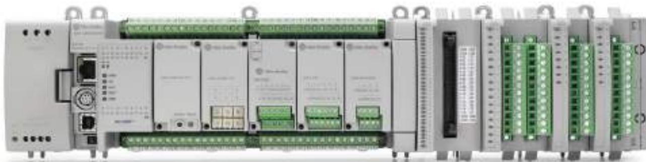
Un automate Micro850 avec une alimentation, des module enfichables et quatre modules d'extension d'E/S associés
