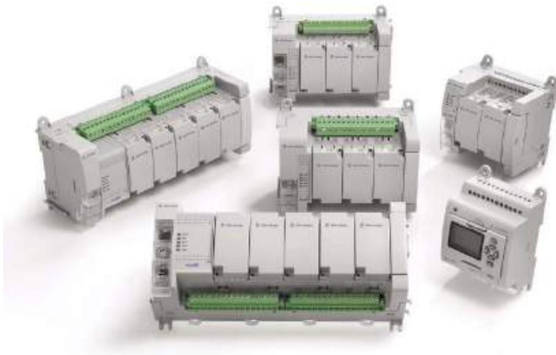
L'automate Micro830 permet d'inclure jusqu'à cinq modules enfichables. Ces modules enfichables apportent aux constructeurs de machines la possibilité de personnaliser les automates et d'accroître leurs fonctionnalités. L'automate offre également des borniers débroschables (sur la plupart de ses modèles) et des communications simplifiées par l'intermédiaire de son port série.
