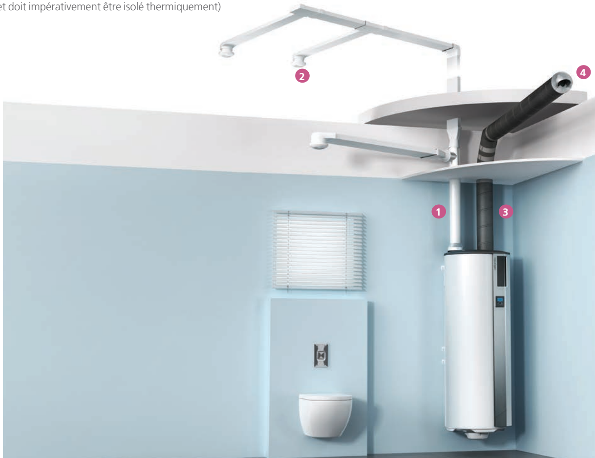
Réseau linéaire en volume chauffé
