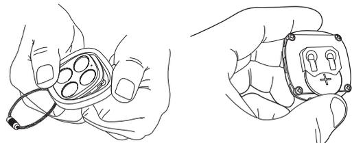
La télécommande est alimentée par une pile bouton de type CR2032. Retirez l'ancienne pile et insérez la nouvelle en respectant la polarité indiquée.
