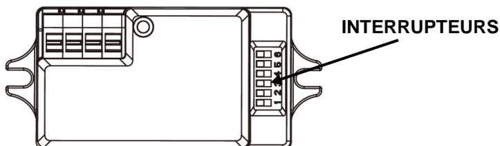
Il contient 6 interrupteurs qui permettent régler la plage de détection, le temps d'allumage et l'utilisation ou non du mode crépusculaire.
