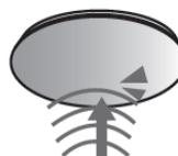
Diode infra-rouge d'émission du signal de commande.
