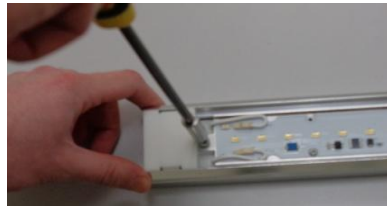
Dévisser la vis de la platine LED.
