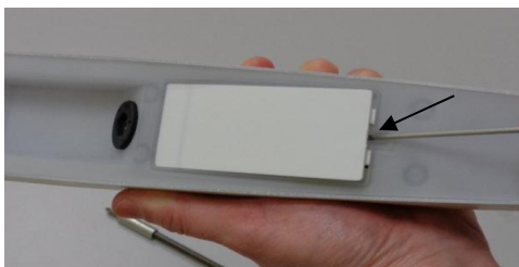
Ouvrir la trappe à l'aide d'un tournevis plat
