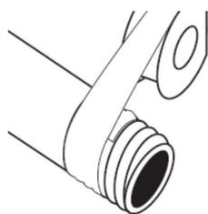
Le maintien de la bobine, comme indiqué sur le dessin ci-dessus, évite de trop dérouler de ruban lors de la mise en œuvre.
