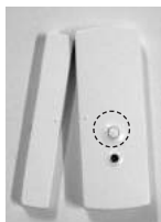
Le voyant AUX s'éteint lorsque le signal d'association du détecteur d'ouverture est pris en compte
