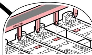
Raccordement par peigne universel de disjoncteur Ph + N avec ou sans auxiliaire 1/2 module
