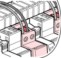
Raccordement des P+N, 3 P, 4 P et auxiliaires sous le peigne HX<sup>3</sup>
