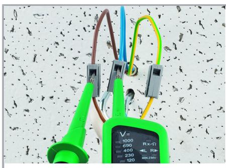
Tester par un point de test séparé.
