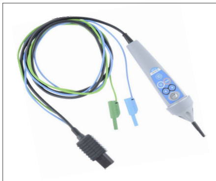
A1401 : Sonde active type pointe de touche
