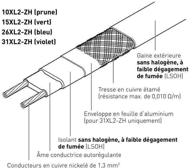
Le ruban chauffant Raychem XL-Trace assure la mise hors gel des tuyauteries dans les zones exposées à des températures négatives et garantit le maintien de l'écoulement des canalisations d'évacuation d'eaux usées.
