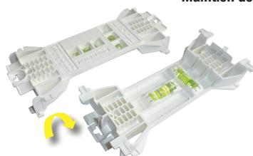
La bride est réversible et peut servir de support universel pour la fixation des panneaux de contrôle dont les entraxes normalisés sont situés en dehors des zones de fixation de la goulotte habituellement utilisées pour les tableaux de répartition.
