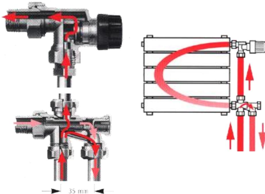
L'eau chaude est véhiculée dans un tube unique de radiateurs en radiateurs. Ce type de distribution se rencontre principalement dans le collectif car sa mise en œuvre est très délicate.
