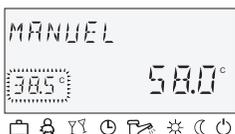
La valeur de consigne de la chaudière est réglée entre les températures minimale et maximale de la chaudière et apparaît clignotante en bas à gauche. La température actuelle de la chaudière apparaît statique à droite dans l'affichage de base. Le différentiel de commutation réglé correspond à la valeur de la régulation automatique.
