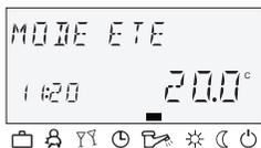
Pour le fonctionnement été manuel, seul le circuit d'eau chaude reste en fonctionnement et régule la température de la chaudière selon la température d'eau chaude sanitaire prédéfinie et le programme horaire d'eau chaude prédéfini. Le chauffage est arrêté protégé contre le gel.
