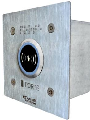
Bouton sans contact C-NO-NF monté sur une façade en acier inox, gravée PORTE. Fermeture par 4 vis anti-vandales. Réglage de la temporisation d'ouverture de 1 à 25 s. Distance de détection : 4 à 12 cm. Dimensions façade (L x H x P) : 100 x 100 x 2 mm. Dimensions du boîtier d'encastrement (L x H x P) : 77 x 77 x 54 mm.
