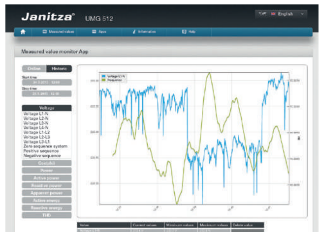
Fig. : Illustration de la page d'accueil avec les valeurs en ligne et historiques avec une App disponible en option.
