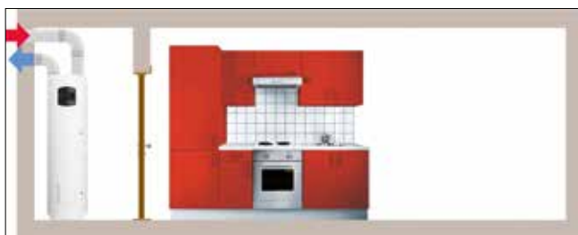
AIR EXTÉRIEUR AVEC GAINÉ POUR NE PAS REFROIDIR LA PIÈCE (DANS UN VOLUME CHAUFFÉ)
