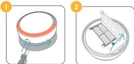
Désactivez l'autoprotection<sup>(1)</sup> puis retirez la sirène du mur à l'aide d'un tournevis (maintenez appuyé et tournez-la dans le sens de la flèche). Ouvrez le capot des piles et procédez au remplacement (4 x 1,5 V alcalines D).
