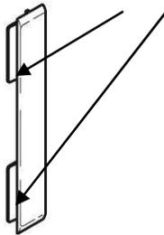
Le joint de couvercle se glisse et se positionne sur l'extrémité d'un couvercle, l'autre côté reste disponible pour réouverture.
