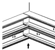
Positionnement des goulottes au mur avant clipsage de l'angle intérieur
