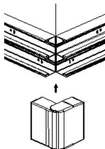
Positionnement des goulottes au mur avant clipsage de l'angle extérieur
