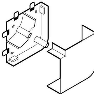
Permet la jonction en angle plat de deux morceaux de goulottes de même section :
