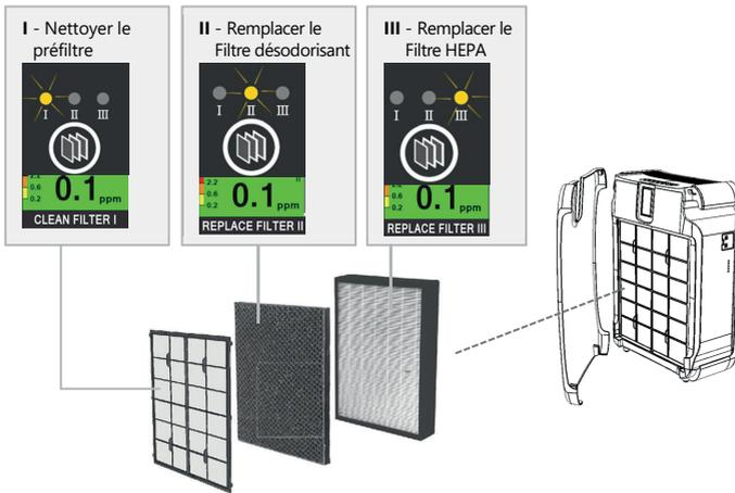
**I** - Nettoyez le préfiltre avec un aspirateur ou à l'eau. Une fois lavé, rincez et séchez le préfiltre soigneusement avant de le remettre dans l'appareil.
