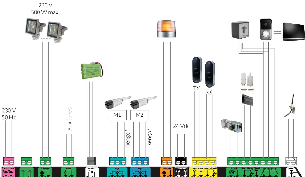
\* bornes réservées au câblage des fins de course des moteurs Ixengo®
