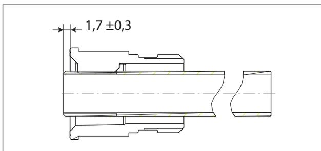
l'insertion correcte de la sonde filetée M12X1 est que, une fois vissé à fond elle dépasse de 1,7 mm du raccord.
