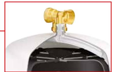
Les vases Airfix D sont équipés d'une pièce en T spéciale assurant la fonction de circulation forcée pour un écoulement complet dans le vase par le biais d'un répartiteur interne.
