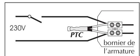
N.B. Si la charge est composée de plusieurs charges de ce type en parallèle, une **PTC** sur une charge suffit.
