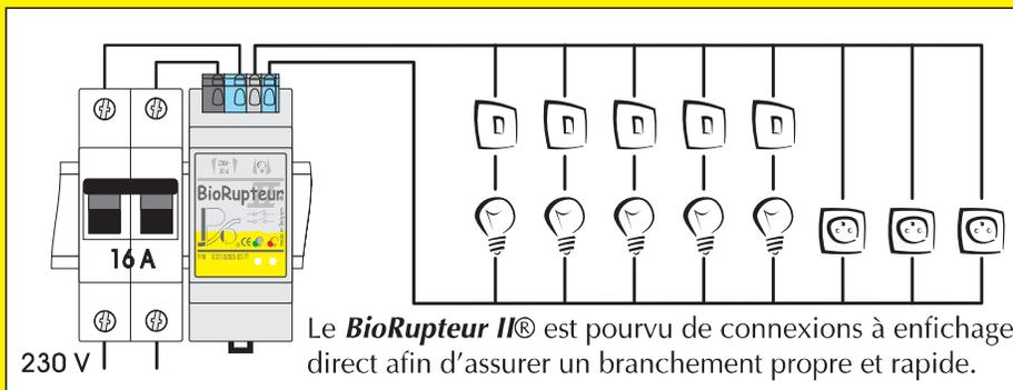
Par sa conception, le **Biorupteur II®** de **PSO** peut être installé sur un réseau de distribution 3 x 400 + N, 3 x 230 ou 230 MONO.
