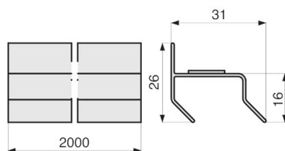
**SUPPORTDISJ - Boîtier d'appareillages 2 modules** - Dimensions
