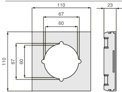
**CSA-CE - Boîtier d'appareillage Prise CE**
