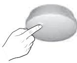
Debe controlar el funcionamiento integral de su detector, una vez al mes o después de cada cambio de pila.
