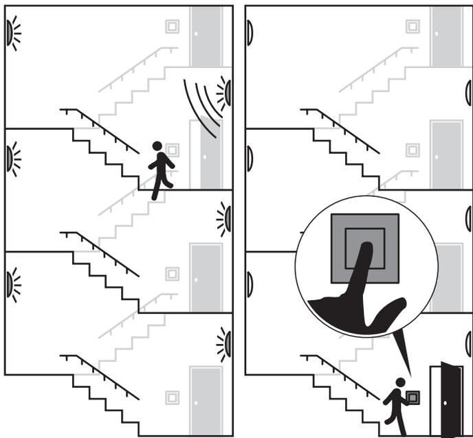
Allumage des tous les hublots sur détection ou appui sur interrupteur
