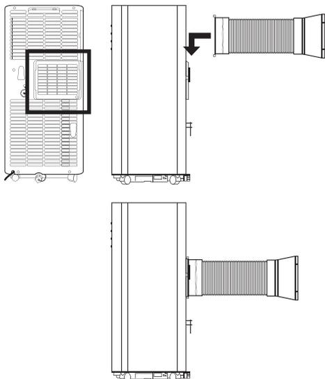
Afin d'avoir une meilleure circulation de l'air conditionné, veuillez installer le climatiseur à plus de 50cm d'un mur/fenêtre.
