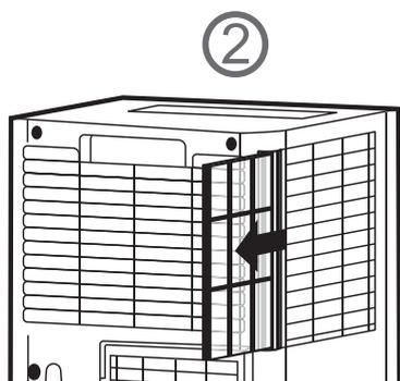
Si le filtre est sale, nettoyez-le dans de l'eau tiède à 40°C ou dans de l'eau légèrement savonneuse.
