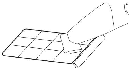
Remonter les filtres en suivant la procédure dans le sens inverse.
