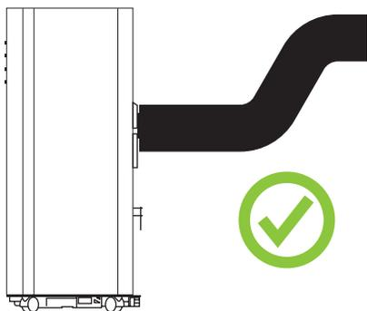
Il est important de garder le conduit d'échappement droit. Une installation incorrecte affectera le climatiseur qui consommera plus afin d'évacuer l'air. Empêchez le conduit d'échappement de se courber.
