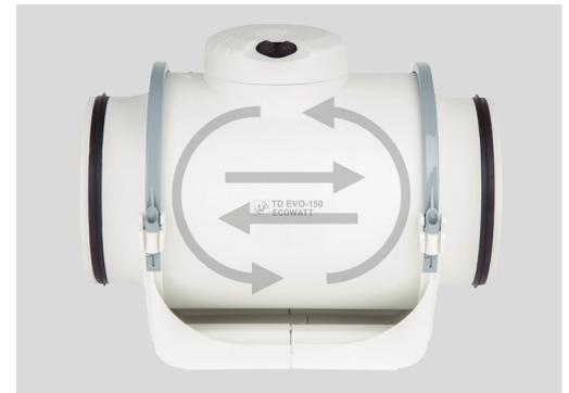
Pour inverser la direction du flux d'air, simplement retourner le corps principal du ventilateur sans avoir à démonter le pied support. La rotation du corps principal du ventilateur permet également de positionner la boîte à bornes à l'endroit permettant la meilleure accessibilité.
