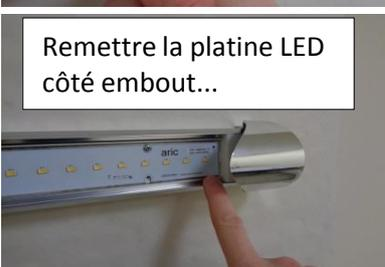
Remettre la platine LED côté embout...
