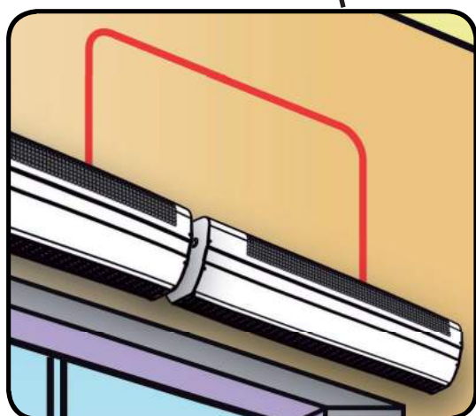
Liaison par 1 fil entre les appareils
