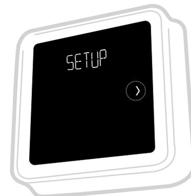
Après la mise sous tension, SETUP (Configuration) s'affiche sur l'écran du thermostat.
