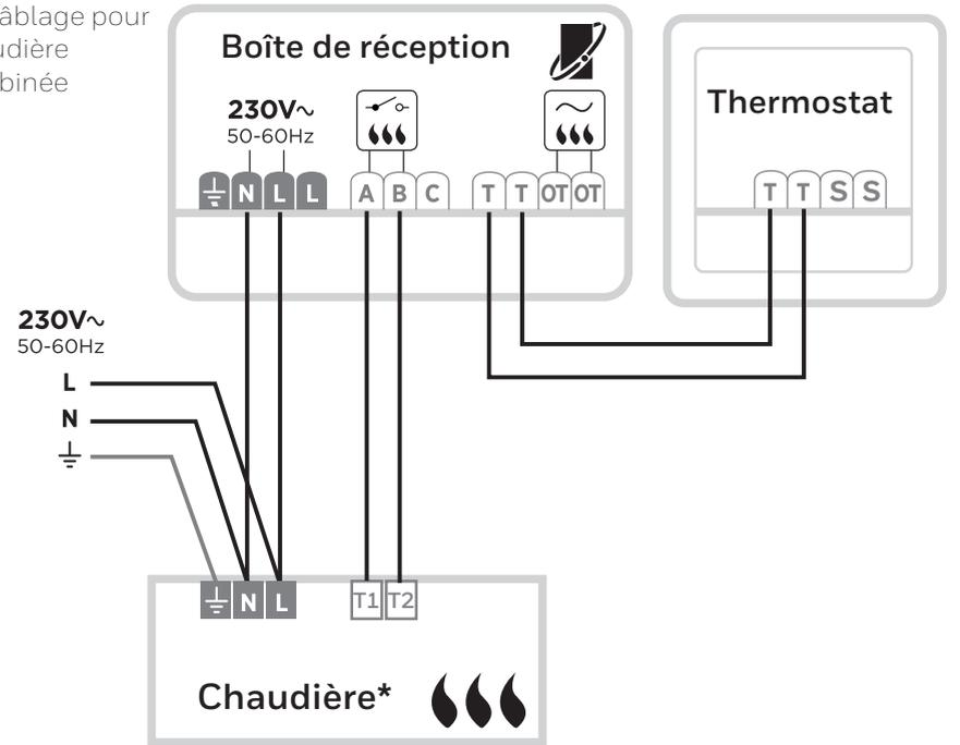
C) Câblage pour chaudière OpenTherm
