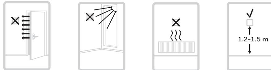
Le thermostat T6 ne doit pas être installé à l'abri des courants d'air, de la lumière du soleil et des sources de chaleur. Il doit être installé à au moins 1.2 à 1.5 mètre du sol.
